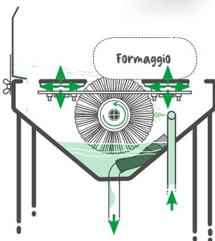
**Impostare altezza e superficie di lavaggio:** è così che si ottiene l'angolo desiderato per il lavaggio del formaggio, che dipende dalle dimensioni e dalla forma del formaggio. In tal modo, si imposta la pressione della spazzola sul formaggio.
