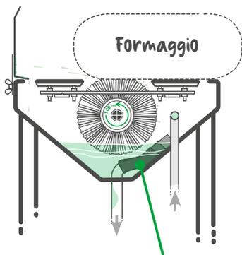
**Impostare il livello acqua di lavaggio:** consente il lavaggio dove non è disponibile l'acqua corrente - è sufficiente riempire il contenitore dell'acqua (opzionale purificatore naturale (bicarbonato di sodio), l'acqua può essere cambiata se necessario).
