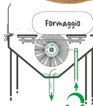
**Impostare la fornitura di acqua fresca:** il lavaggio con solo acqua fresca garantisce la massima qualità di lavaggio. È possibile impostare la velocità di risciacquo della spazzola aprendo e chiudendo la valvola.
